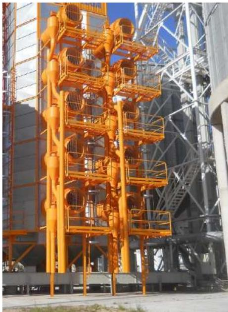
**Imagen 02. Secadora de granos fuera de funcionamiento.**
